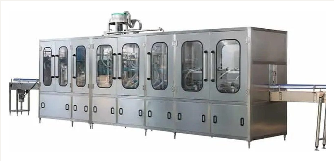
FIG. 09 — TRÁNG RỬA, CHIẾT RÓT, XOÁY NẮP VÀ SOI DỊ VẬT
