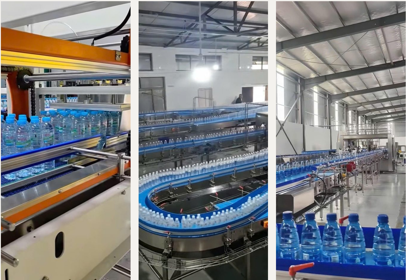
FIG. 13 — CO MÀNG NHÓM CHAI, BĂNG TẢI CHAI THÀNH PHẨM, XẾP PALLET
